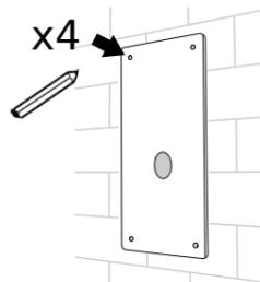
Percez les 4 trous de fixation avec un foret de diamètre 6 mm, puis insérez les chevilles :
